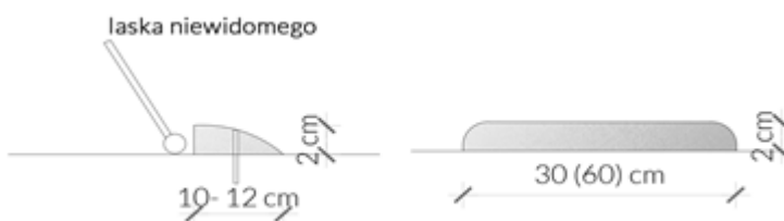
Rys. D3 – Profil rozdzielający ruch rowerowy od pieszego. Sygnalizujący koniec ciągu pieszego
